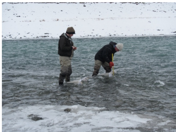
Mynd 3: Rekháfum hefur verið komið fyrir á botni á stöð JD3 í Jökulsá á Dal þann 28.10.2014. Dýpi framan við háfa við botn og við munna var mælt.
